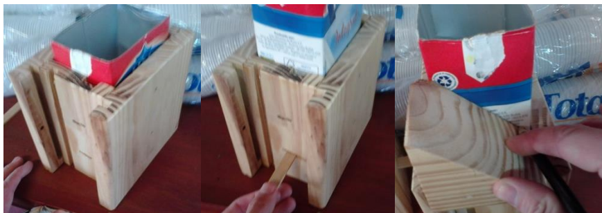
Figura 2: Gabarito de madeira com representação dos níveis e marcação transversal para corte manual.
