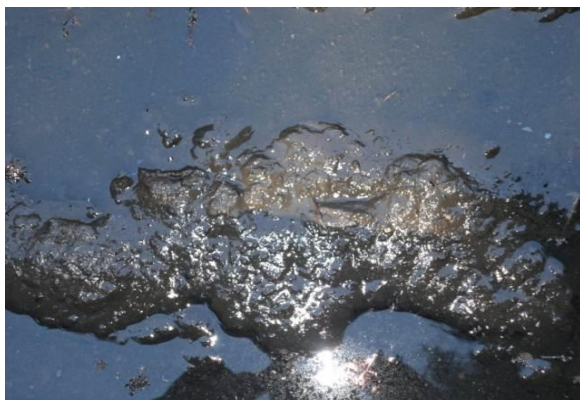
Figura 3 - Lodo de esgoto recebido da estação de tratamento (com teor de umidade elevado).
