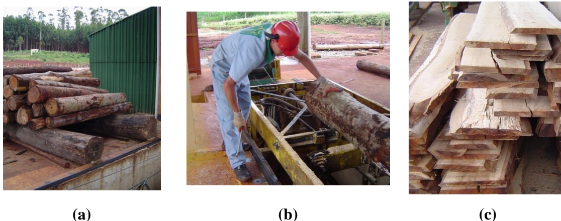
Figura 3: (a) Pátio de tora; (b) Fixação da tora no carro porta-toras; (c) tábuas produzidas na Pica-Pau
