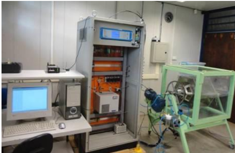
Figura 1 - Estrutura do processo de experimentos de compostagem formada basicamente por: a) tambor rotativo, b) analisador de gases e c) microcomputador para aquisição de dados.
