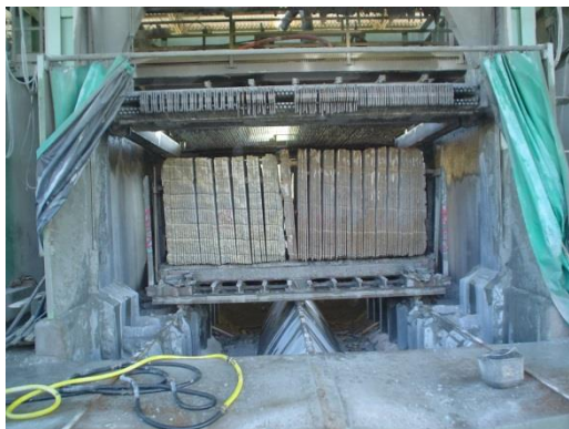
Figura 3 – Tear com seu quadro de lâmina levantado mostrando dois blocos serrados e lavados.
