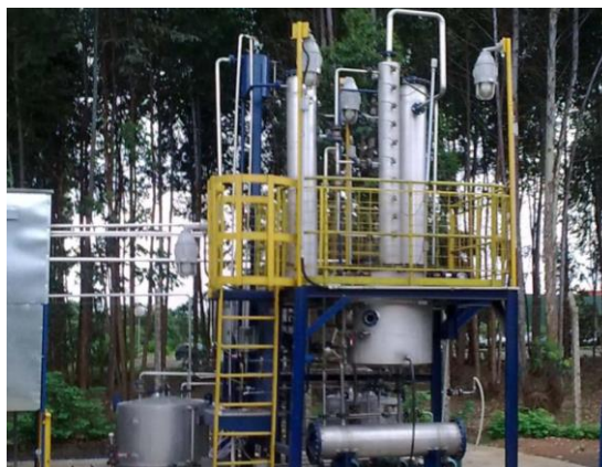
Figura 1: Planta piloto para recuperação de solventes orgânicos gerados em laboratórios da UFSCar.
