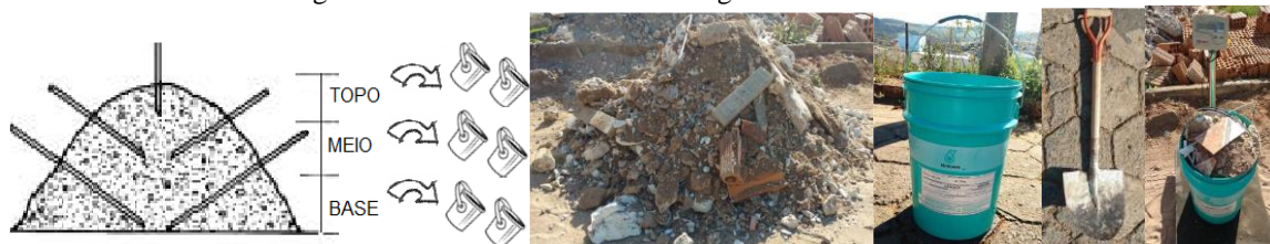
Figura 2 – Procedimento de amostragem física NBR 10.007:2004.
