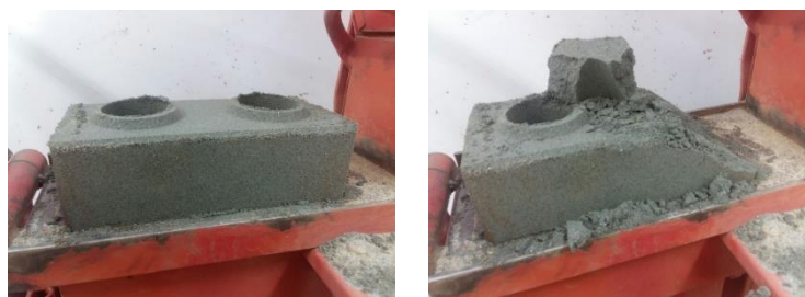
Figura 3 - Bloco com 100% de resíduo (a) antes do manuseio (b) após a tentativa de manuseio
