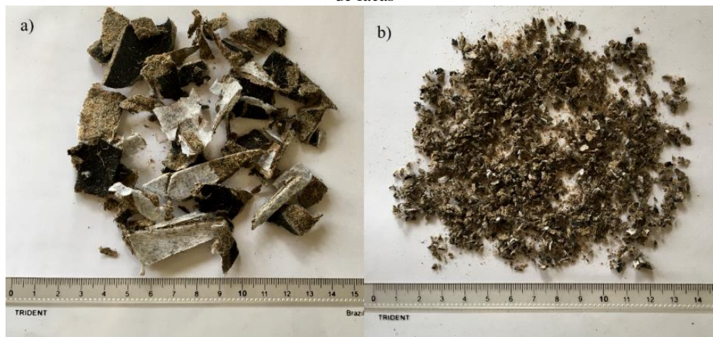
Figura 2 – a) Resíduo recebido da empresa Tapetes São Carlos. b) Resíduo depois de diminuído em moinho de facas
