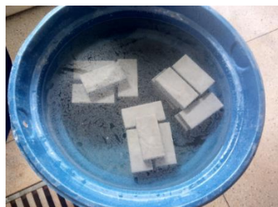
Figura 2: Blocos armazenados em solução saturada de hidróxido de cálcio para cura.
