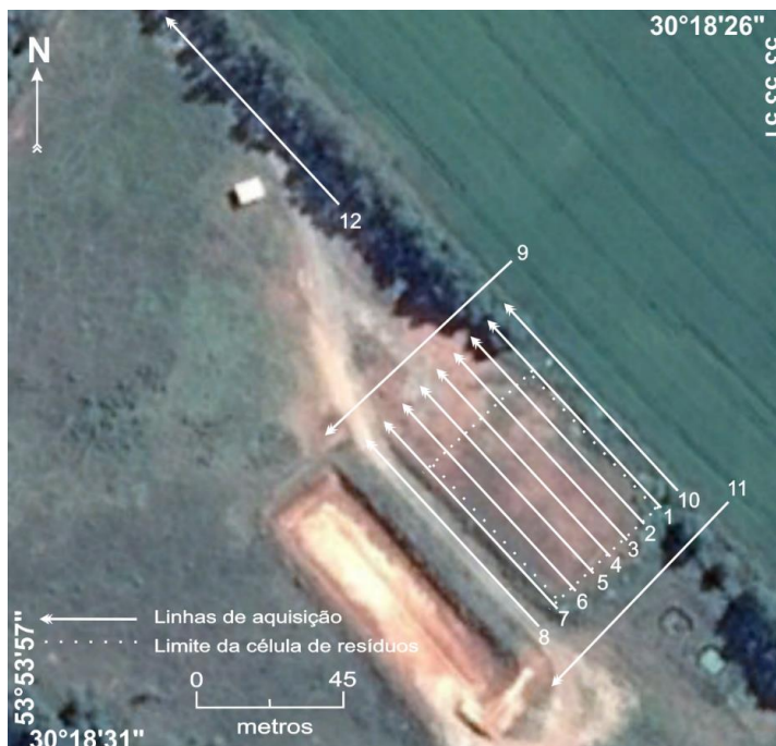
Figura 1 – Disposição das linhas de aquisição geofísica
